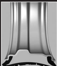
Standard-Reifen Der Reifen wird bei Luftverlust eingeklemmt und zerstört.
